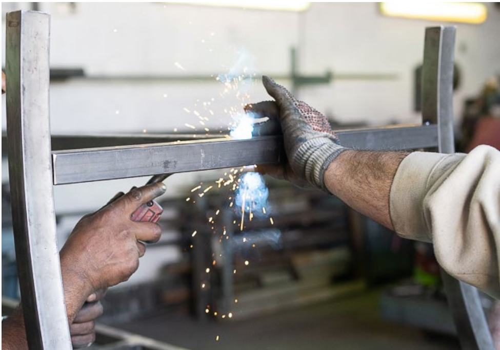
Работата с метал беше ново предизвикателство — огъване, рязане и заваряване на стоманени профили. Грундирането и боядисването правихме при вече сглобени елементи.
