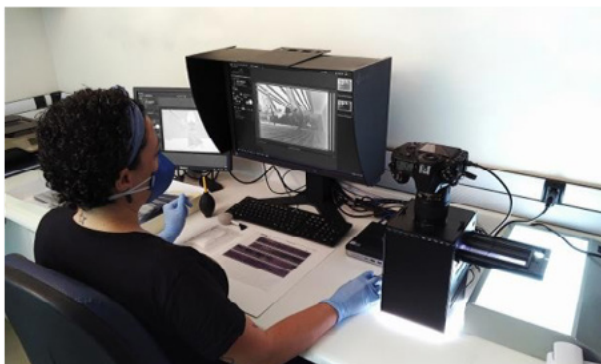
Figura 9. Ponto de digitalização em uso. Plataforma Windows conectada ao Sistema FilmToaster .
