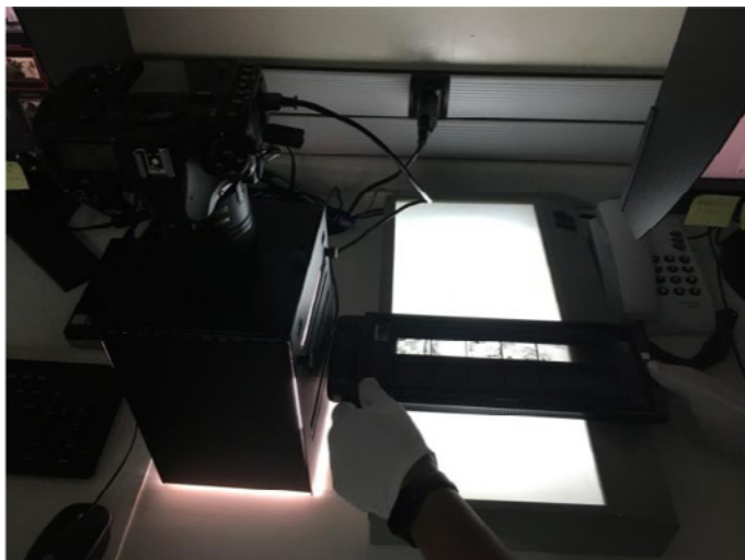
Figura 15. Verificação do posicionamento da tira 35mm dentro das divisórias do holder 35mm.
