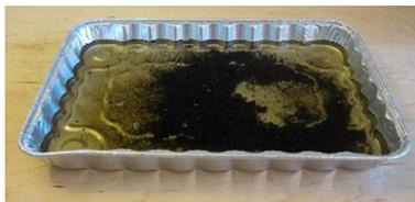
9. Escorra com cuidado a água da forma, sem derramar nada de terra, para ficar apenas com a terra na forma, conforme mostrado na Figura 12. Essa é a terra que foi erodida da sua "encosta" [o pão panela] pela "chuva" do seu regador. Observe que uma pequena quantidade de terra suspensa na água também pode escorrer da panela, mas deve ser uma quantidade pequena o suficiente para não afetar seus resultados.
