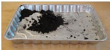
10. Use sua balança de cozinha para medir a massa da fôrma e da terra. Subtraia a massa de uma forma de bolo vazia (que você deveria ter medido anteriormente) da massa combinada do solo e da forma, para calcular apenas a massa do solo. Insira este valor em sua tabela de dados.
